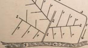
Abb. 1. Rohr-Drainage: 1 = Saugstränge 2 = Sammelstränge 3 = Kephörsen 4 = Vorläufer
